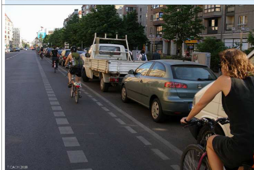
Corsia ciclabile integrata con fascia di sosta
