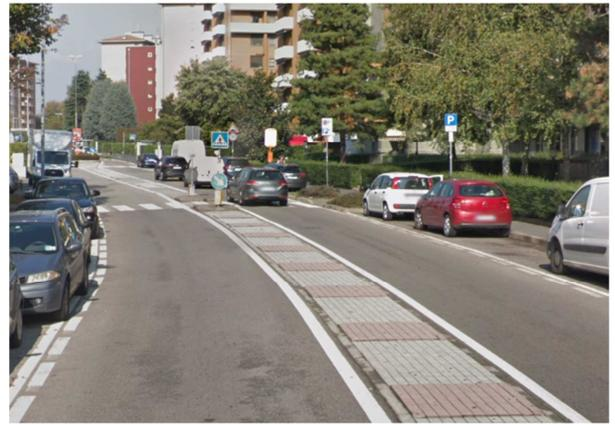
*Esempio di parterre centrale semisormontabile, con inserimento delle isole di protezione dell'attraversamento pedonale (Settimo M.)*
