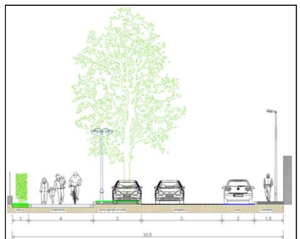
Possibile sezione-tipo per via Grandi
